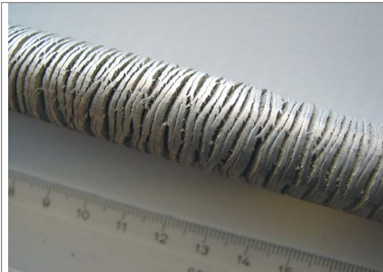
Abb.2.13: Heißrisse auf der Oberfläche des Mg-Profiles /Vir04/.
