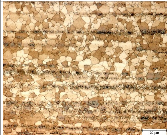
Abb.4.111: Gefüge von feinkörnigem (hydrostatisch stranggepresst), wärmebehandeltem AZ61.
