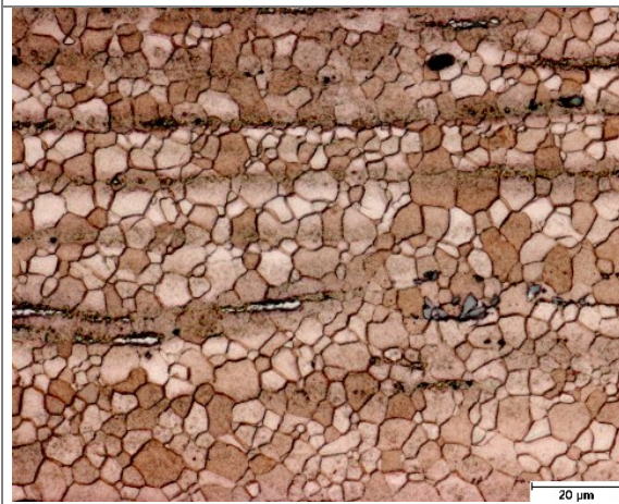
Abb.4.40: Legierung AZ61, Wasserkühlung, Rundprofil Ø15 mm, T_S=300^{\circ}\text{C} , \psi=28.4 , v=5.1\text{m/min} , mittlere Korngröße 5\mu\text{m} (Strangpressrichtung →).
