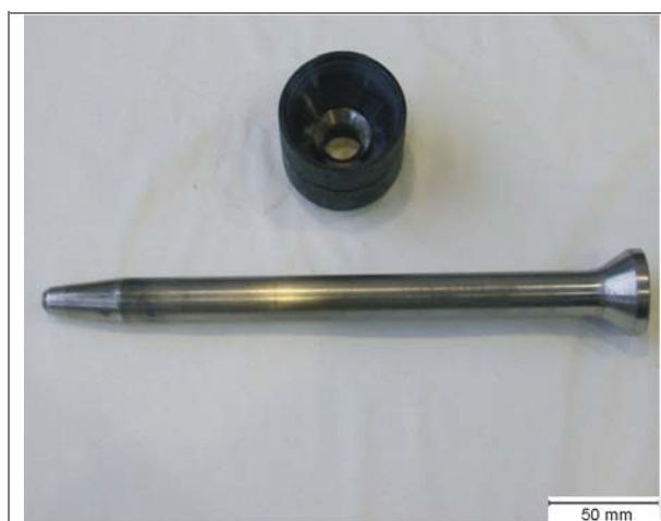
Abb.3.10: Matrize und Dorn zum Strangpressen von Rohren.
