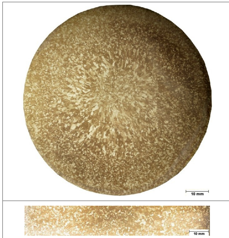
Abb.4.2: Stranggussbolzen AZ61, Quer- und Längsschliff .
