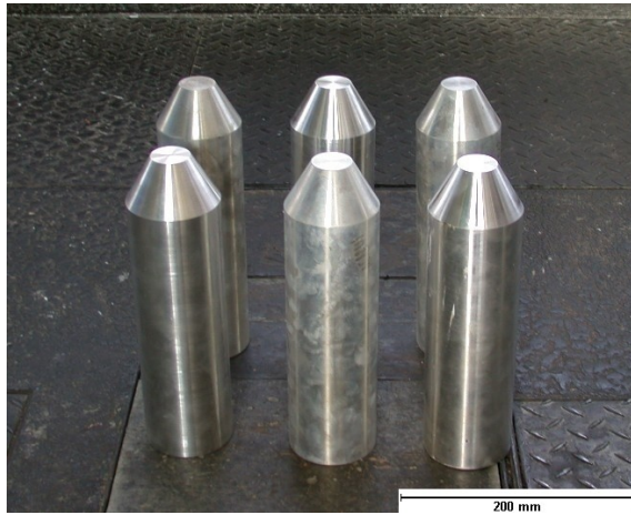
Abb.3.8: Abgedrehte Pressbolzen kurz vor dem Strangpressen.
